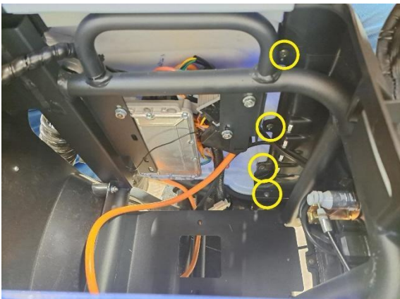
Irrota istuimen vasemmanpuoleisen alasivumuovin kiinnitysruuvit (ristipäämeisseli ph2).
